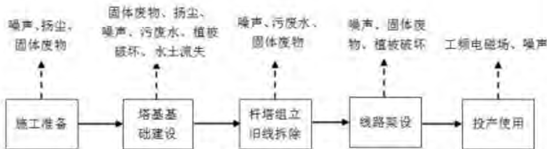
图 2-6 架空线路工程工艺流程及产污环节
