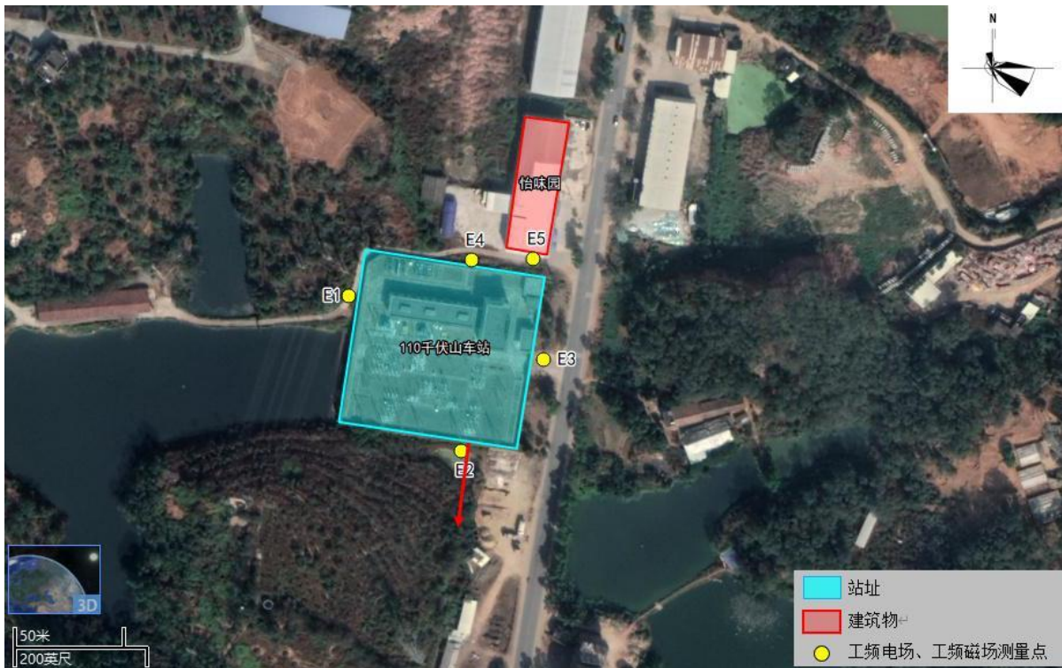
图 8-1 110kV 山车变电站类比监测布点图
