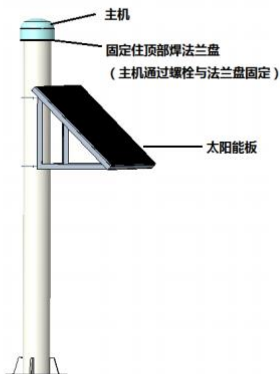
图 5-9 全自动 GNSS 地表位移样图
