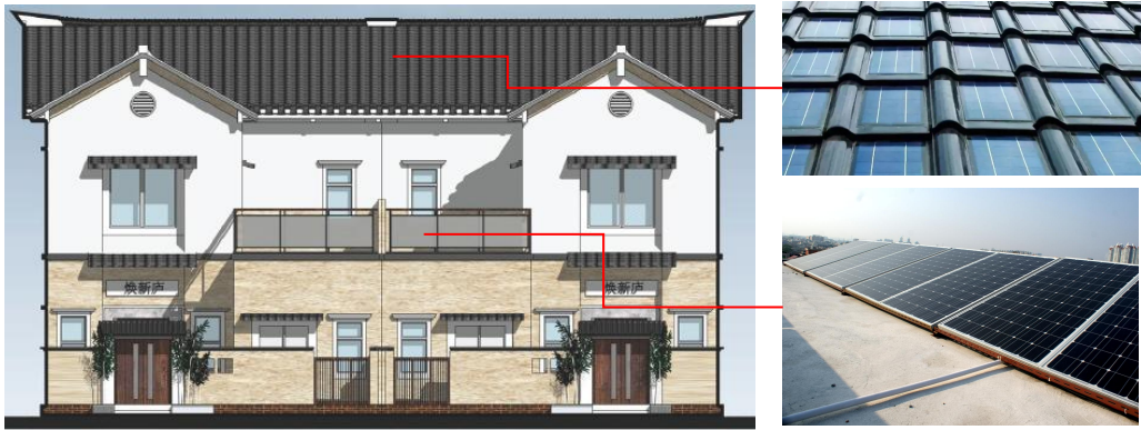
图A.0.4-3 绿色农房外太阳能光伏设置示意图
