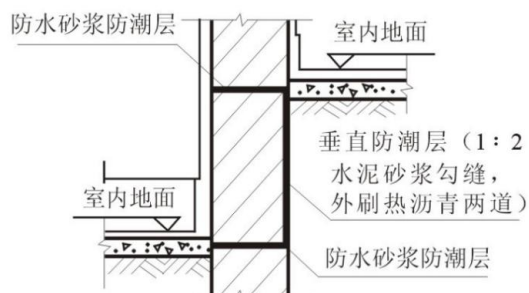
图 A.0.1-2 墙面垂直防潮层示例
