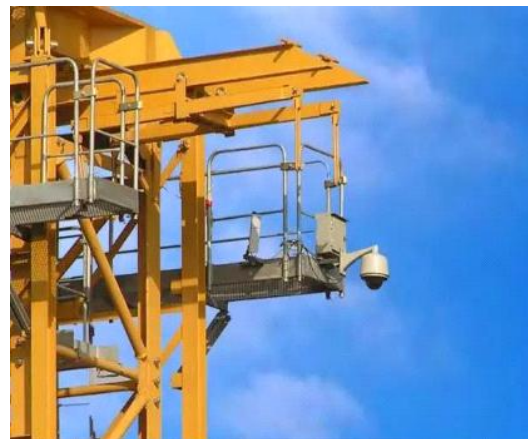
塔吊视频监控示例图
