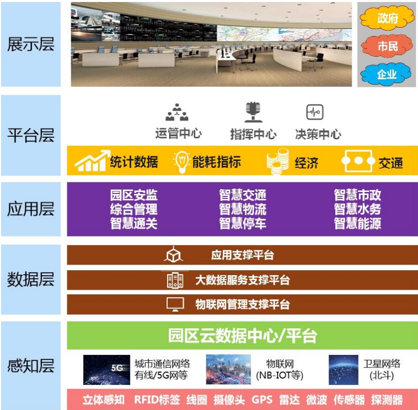
图 6.1-7 智慧园区总体架构示意图
