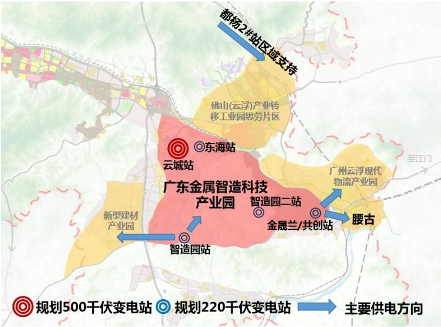
图 5.16 东部片区 500 千伏和 220 千伏变电站布局图
