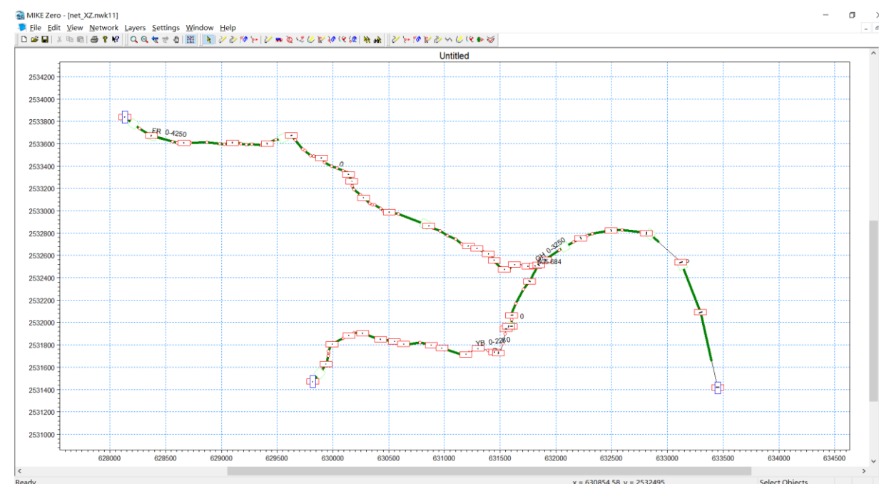
图 4.3-9 河网模型图 (芙蓉支流概化为桩号的节点汇水面积)
