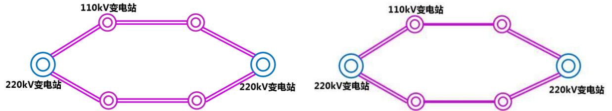
图 5.1-4 金属智造园 110 千伏电网典型结构
