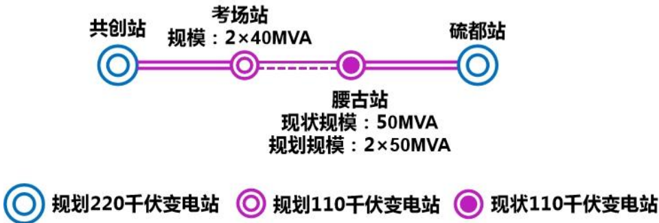
图 5.1-9 现代物流产业园 110 千伏电网结构图
