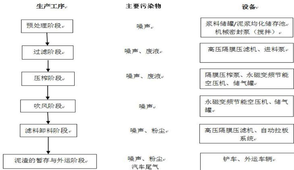
图 2-2 项目生产流程及产污节点图
