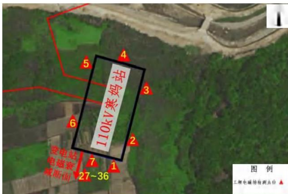
图 1 揭阳 110 千伏寒妈变电站监测布点图
